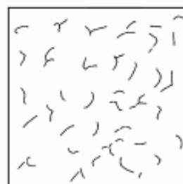
Рисунок А.10 – Короткие, случайные трещины
