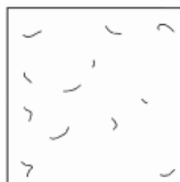
Рисунок А.10 – Короткие, случайные трещины
